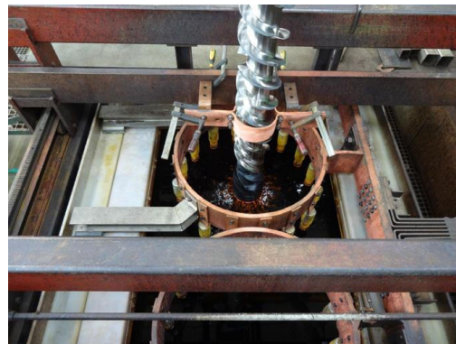
Figura 9: le fotografie mostrano un serbatoio verticale utilizzato per parti di dimensioni maggiori per diversi settori (ingegneria, automobilistico, aerospaziale, petrolio e gas, estrazione mineraria, idraulica, ecc).
