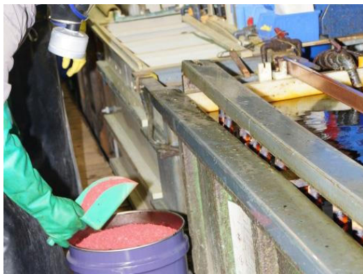
Figura 4: questa foto mostra la regolazione del bagno con triossido di cromo
