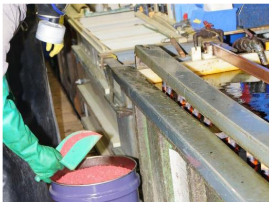
Figura 7: questa foto mostra la regolazione del bagno con triossido di cromo
