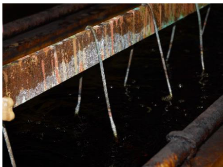
Figura 14: le fotografie mostrano (a sinistra) le scaffalature di parti immerse in un bagno di trattamento superficiale e (a destra) un cesto di parti rimosse da un bagno di trattamento superficiale. Il cestello è inclinato per consentire un migliore drenaggio e ridurre il trascinarsi della soluzione del processo nella vasca di risciacquo.
