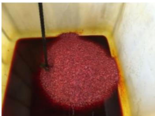
Figura 3: le fotografie mostrano fiocchi di triossido di cromo con aggiunta di acqua per ridurre la polvere durante la miscelazione (figura di sinistra) e fusti vuoti (figura di destra)
