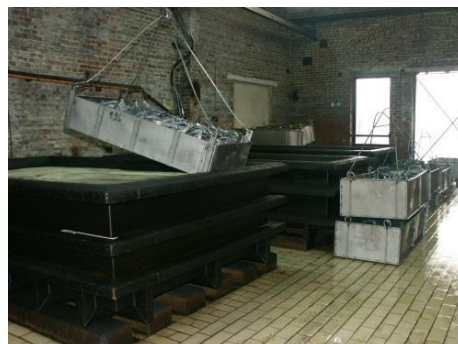
Figura 14: le fotografie mostrano (a sinistra) le scaffalature di parti immerse in un bagno di trattamento superficiale e (a destra) un cesto di parti rimosse da un bagno di trattamento superficiale. Il cestello è inclinato per consentire un migliore drenaggio e ridurre il trascinarsi della soluzione del processo nella vasca di risciacquo.
