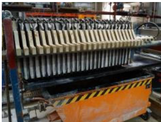
Figura 15: le fotografie mostrano il serbatoio di contenimento delle acque reflue (a sinistra) e la filtropressa per la disidratazione dei solidi nell'impianto di trattamento delle acque reflue (a destra)
