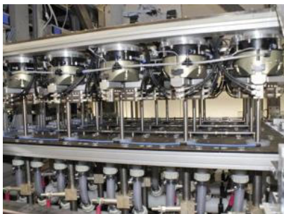
Figura 10: le fotografie mostrano le celle del reattore chiuse utilizzate nella galvanizzazione di bielle e valvole del motore
