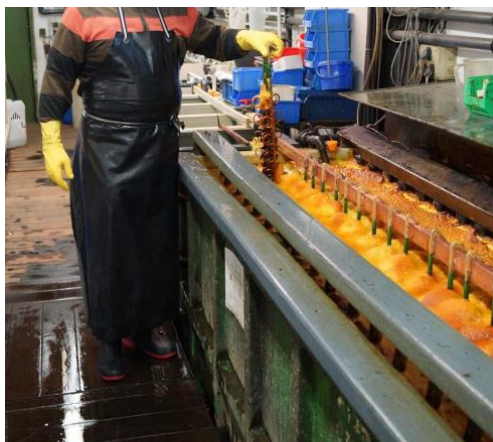
Figura 8: la fotografia mostra la galvanizzazione a serbatoi aperti con caricamento manuale
