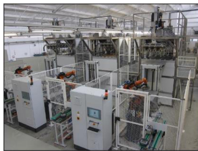
Figura 10: le fotografie mostrano le celle del reattore chiuse utilizzate nella galvanizzazione di bielle e valvole del motore
