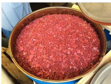
Figura 1: la fotografia mostra un fusto aperto contenente fiocchi di triossido di cromo
